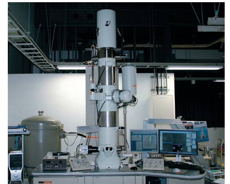
図2 ●ダブル球面収差補正レンズ付きの透過型電子顕微鏡 (加速電圧は200kV)
