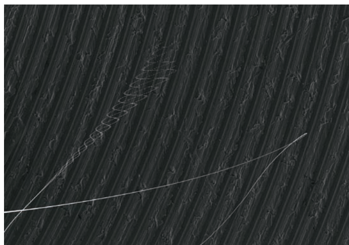
図1●金属ガラスナノワイヤーの走査型電子顕微鏡像。中央部の細長い線がナノワイヤー。金属ガラスナノワイヤー作製装置で作製
